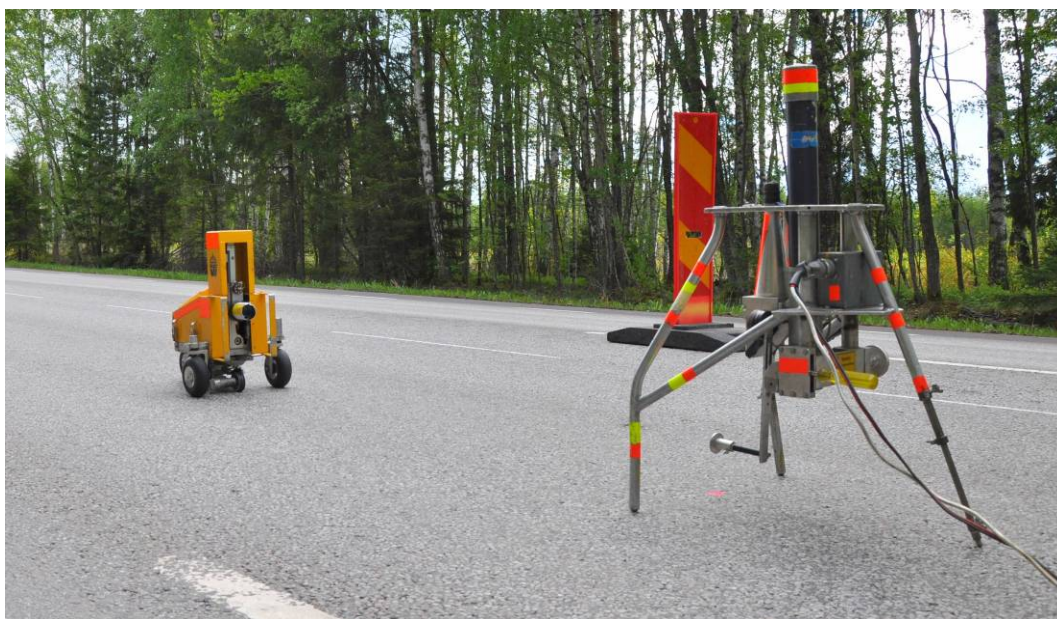
Figur 3. Profilmätning med PRIMAL. Figuren visar bestämning av längsprofil.
